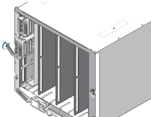
図3. クォータハイトブレードの取り付け
