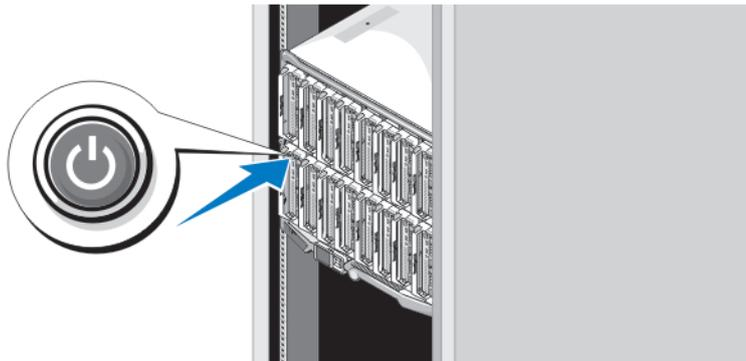
図 8. ブレードの電源投入
