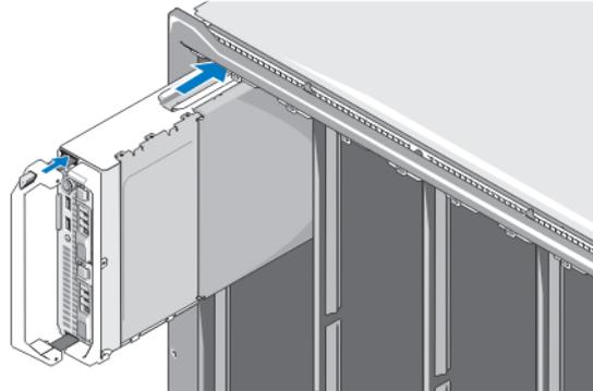
図 4. ハーフ高さブレードの取り付け
